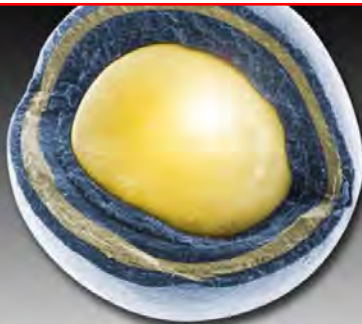
Aufgeschnittenes TRISO-Kügelchen in Falschfarben; das Partikel hat einen Durchmesser von weniger als 1 mm – Illustration: ENERGY.GOV/Wikimedia
